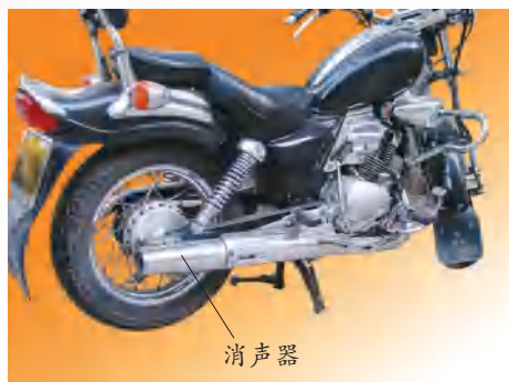
(a) 在摩托车发动机上安装消声器
