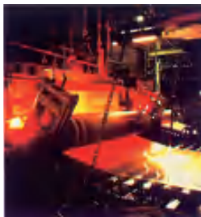
图 2-35 将熔融状态的玻璃轧制成玻璃板
