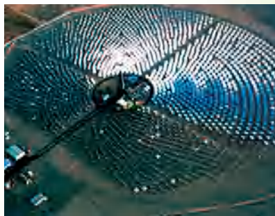
图3-12 反射式太阳能发电站
